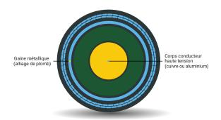
Le câble est protégé par une armure métallique. À la manière d'une cage de Faraday, **elle bloque totalement le champ électrique**.
